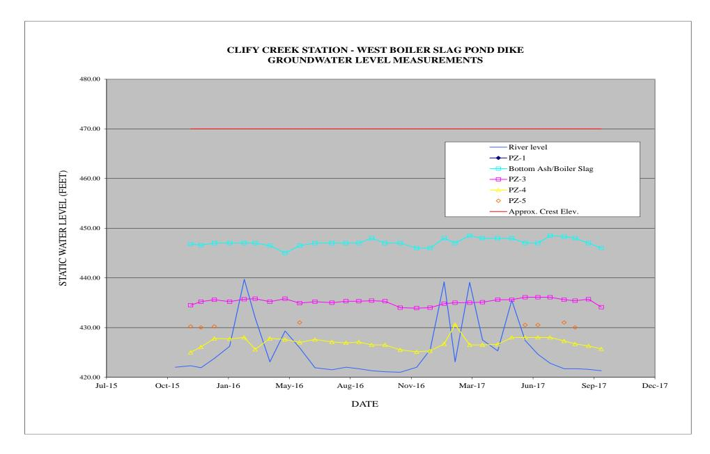
FIGURE 2. WEST BOILER SLAG POND GROUNDWATER LEVEL MEASUREMENTS
